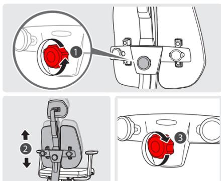
Слегка ослабьте центральный винт, поворачивая против часовой стрелки (1). Установите спинку на нужную высоту (2). Закрутите винт поворачивая по часовой стрелке (3).
