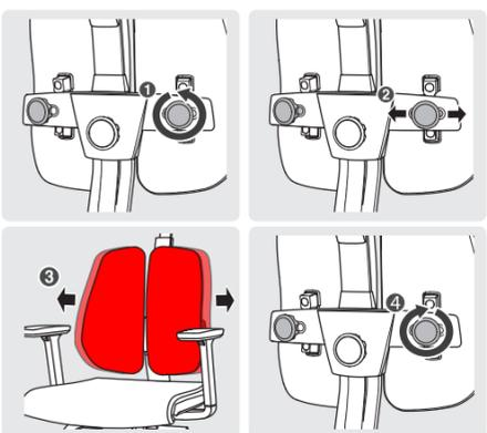
Слегка ослабьте винты на задней части спинки (1). Передвигая винты совместно с спинкой, установите удобную ширину спинки (2 3) и затем зафиксируйте спинку закрутив винты по часовой стрелке (4).
